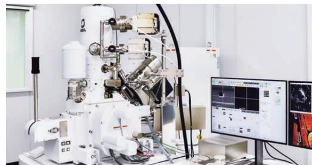
透過型と走査型の2台のクライオ電子顕微鏡が導入され、INGEMが運用しています。単粒子解析やクライオ電子線トモグラフィ解析の他、東北メディカル・メガバンク棟内のスーパーコンピュータ上の解析環境も利用でき、多様な生体高分子の構造解析による疾患発症メカニズムの解明や創薬の実現が期待されます。学外の企業・研究機関等の利活用も積極的に受け入れ、30件以上（2025年1月時点）の利用実績があります。
