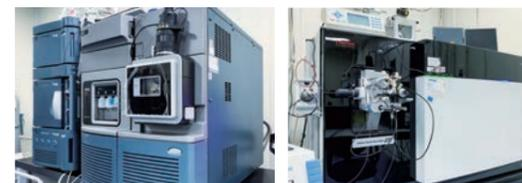
メタボロームおよびプロテオーム解析に用いる質量分析装置
