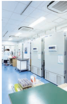
-80℃の超低温フリーザーで生体試料を適切に管理
