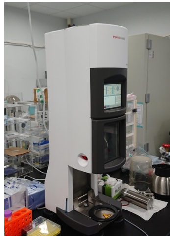
グリッド凍結装置 Vitrobot Mark IV (Thermo Fisher Scientific社製)
